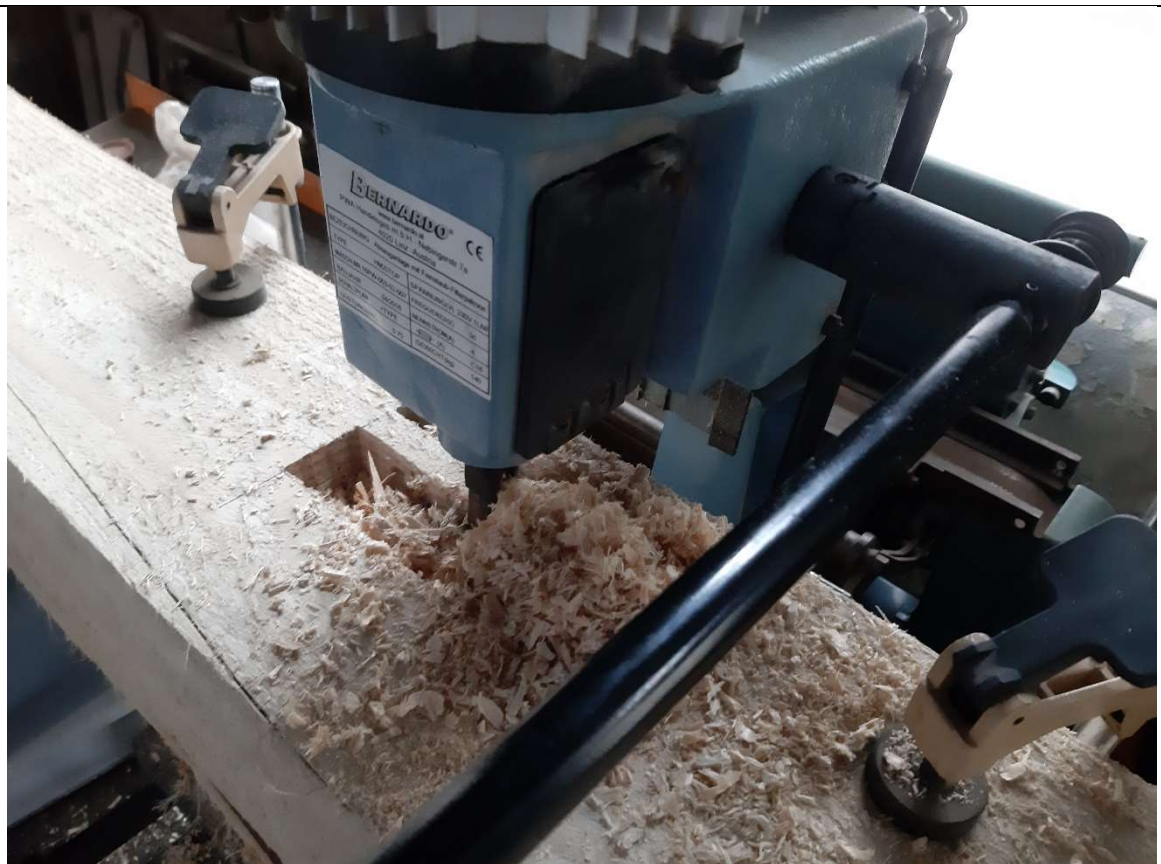
Dank Stemmmaschine gelingt das Setzen der Löcher für die Zapfverbindungen gut. (AT)
